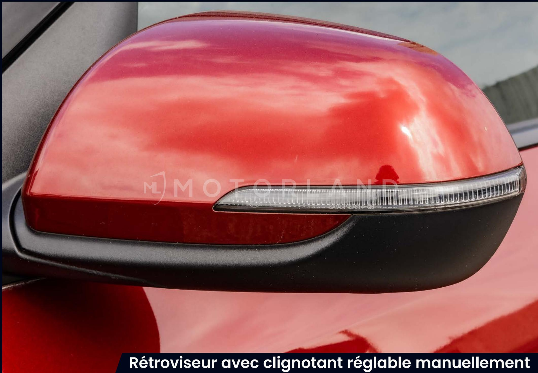
**Rétroviseur avec clignotant réglable manuellement**
