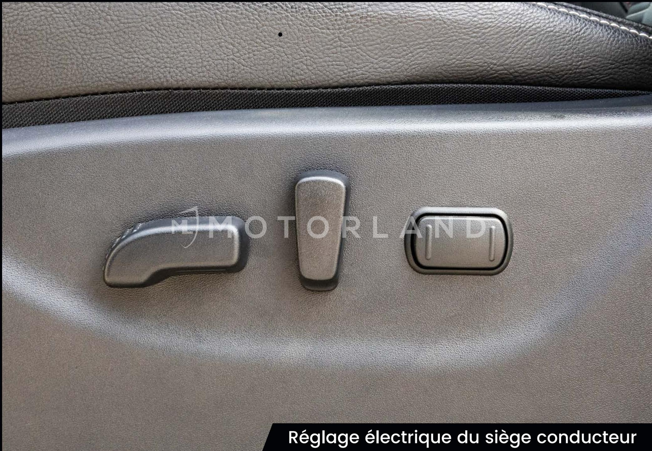
Réglage électrique du siège conducteur
