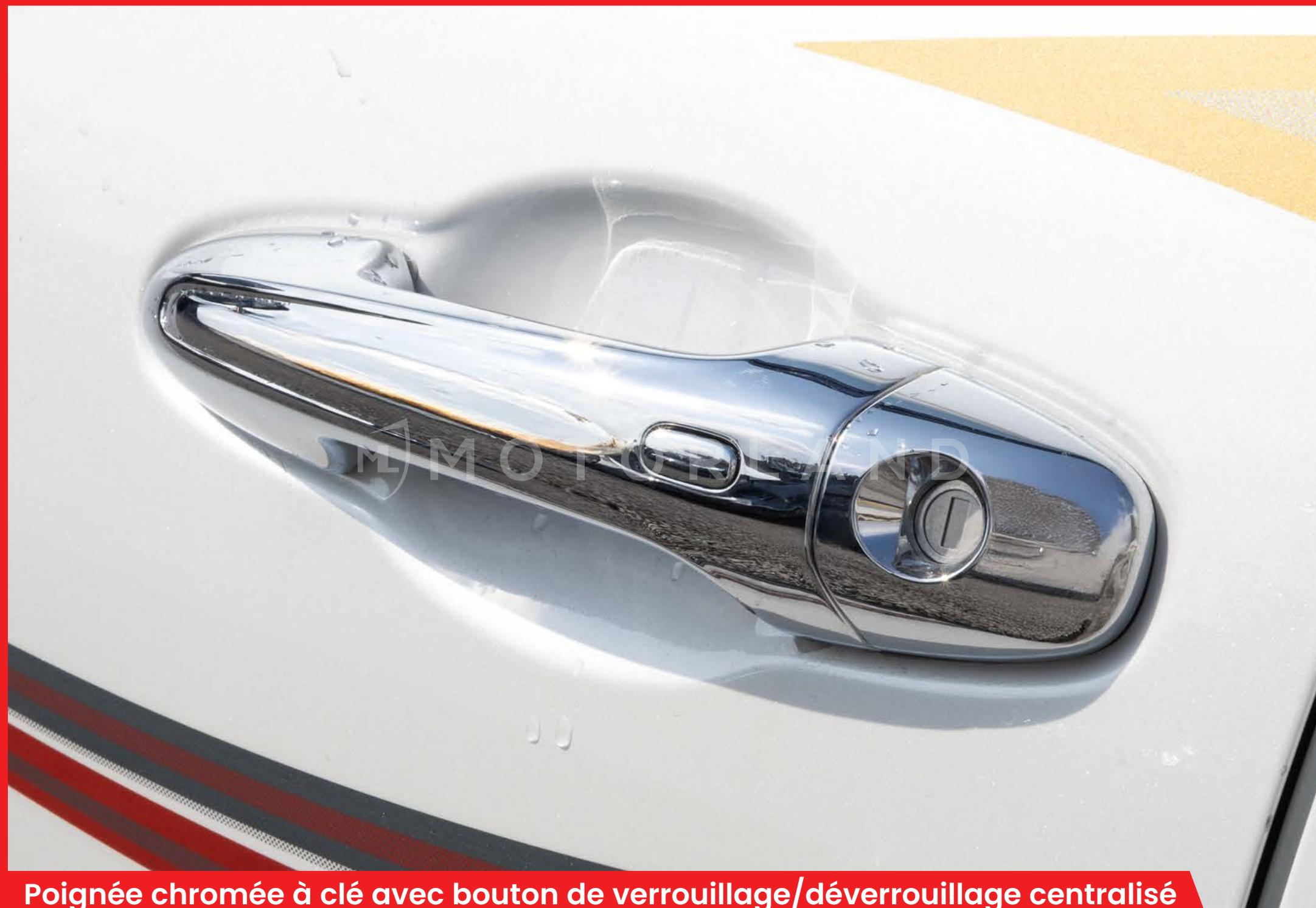
Poignée chromée à clé avec bouton de verrouillage/déverrouillage centralisé
