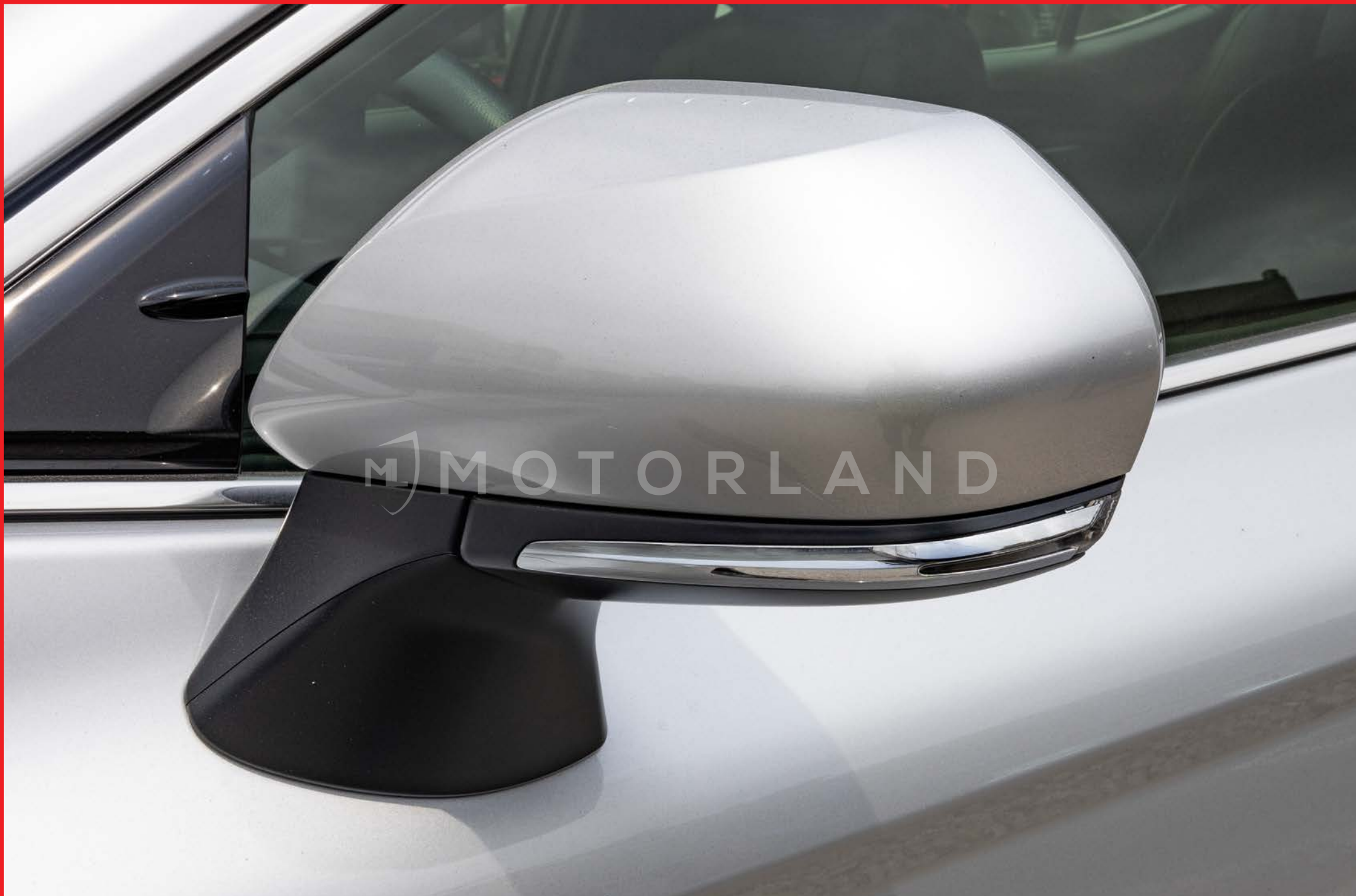
Rétroviseurs extérieurs électriques avec clignotant latéral
